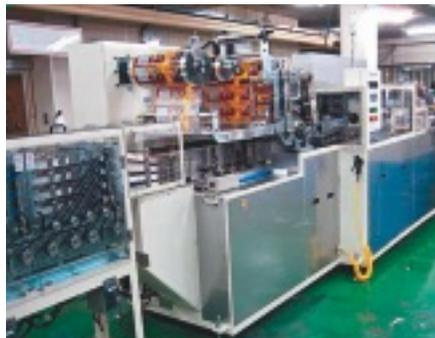
1000帯掛け包装機及び段積み移り装置
