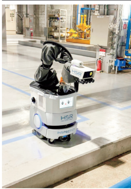
▲導入された巡視点検業務ロボット
